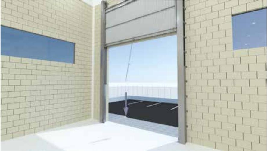
**2.2** Cuando la puerta se encuentre a una altura alcanzable con la mano, sin dificultad, sujetar ésta por el tirador y empujarla con suavidad hasta que se encuentre completamente cerrada y la hoja superior haya hecho contacto con los topes inferiores de las guías.
